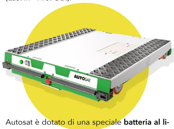
Autosat è dotato di una speciale **batteria al litio estraibile** del peso di 9 kg per un'autonomia fino a 10 ore, ed è comandato da un radiocomando multifunzione.
