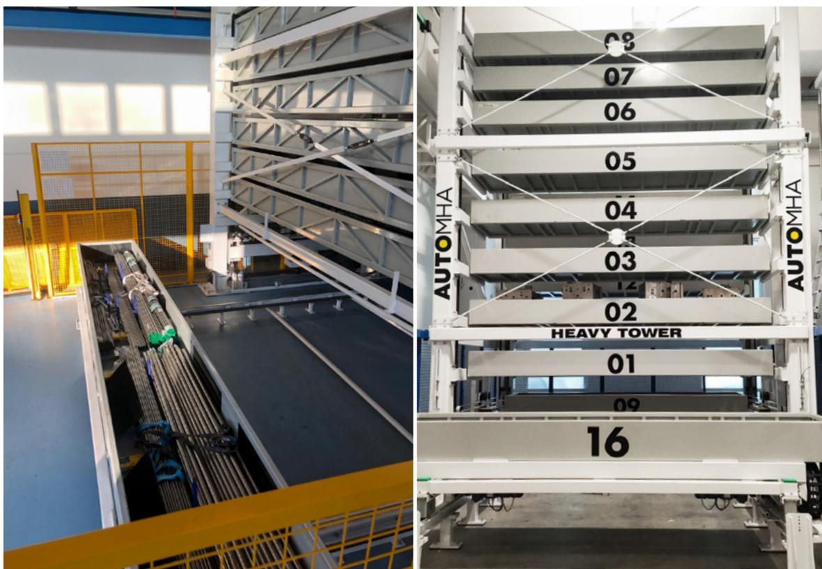
Heavytower si configura come **buffer interoperazionale** ed è affiancata a macchine da taglio e produzione. **Heavytower di Automha è la soluzione ideale per lo stoccaggio di barre e profilati in acciaio, tubi, accessori pesanti, semilavorati, componenti, stampi e materiale ingombrante in genere.**
