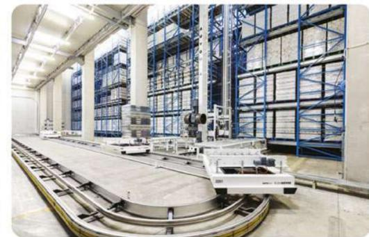
Cavrio, il magazzino del vino Tavemello, con il Rushmover di Automha, circuito modulare completamente automatico per il trasporto di ogni tipo di pallet
